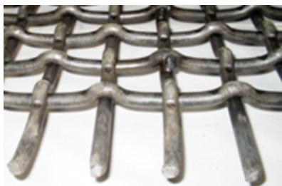
Nesse tipo de tela, a superfície de trabalho apresenta-se plana, com substancial redução de ficção do material a peneirar, e conseqüentemente com maior durabilidade. Em virtude do encaixe de sua ondulação, as aberturas se mantêm perfeitamente regulares, mesmo em telas com aberturas grandes em relação ao diâmetro do fio.
